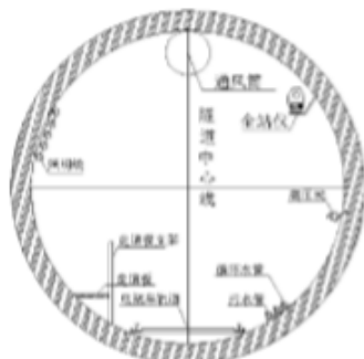
盾构隧道内管线布置剖面示意图
